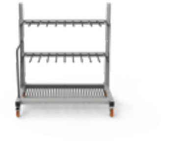
Carr 200 Q / Carr 300 Q Chariot pour le transport et le stockage de profils verticaux Carr 200 Q Largeur: 912mm - Longueur: 1282mm. Carr 300 Q Largeur: 912mm - Longueur: 1718mm. Surfaces de contact en matériel plastique anti-choc et anti-rayures.
